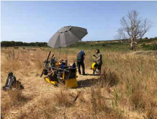
33 Selinunt, Cotonetal. Rammkernsondierung. (Foto: M. Schlöffel/DAI)
