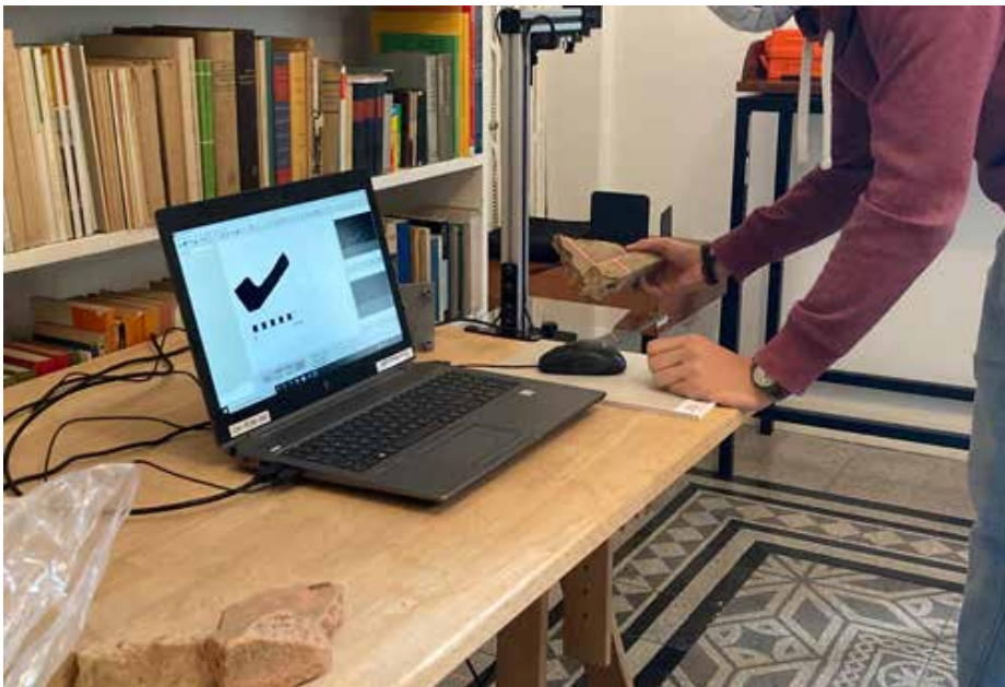
12 Dokumentation des Fragmentes eines Dachziegels aus Castiglione/Vetulonia mit dem Laser Aided Profiler. (Foto: C. Colombi/DAI)
